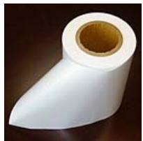
エコネージュは、ポリプロピレンを原料とした乳白色の二軸延伸フィルム。フィルム内の微細な空気層(ボイド)によって美しい乳白色を呈し、かつボイドの分原料が不要な為、一般OPフィルムと比べ20~30%軽量。紫外線カット性・遮蔽性が高い上に、従来必要だった白色印刷を不要にした環境に優しいフィルムです。(三井化学東セロ)
